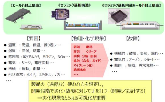
図8 車載パワエレ製品における劣化現象
