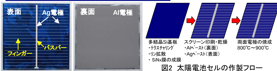
図1 多結晶Si太陽電池セルの外観（5cm×5cm）[東京農工大学 上迫研究室にて作製]
