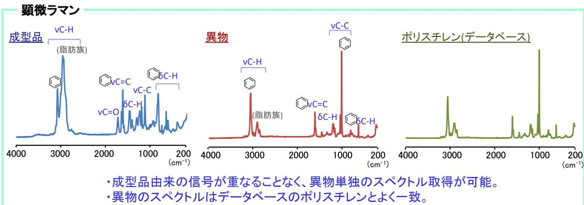
⇒ 成型品内部の微小な異物であっても、空間分解能の高い顕微ラマン測定により定性が可能。
