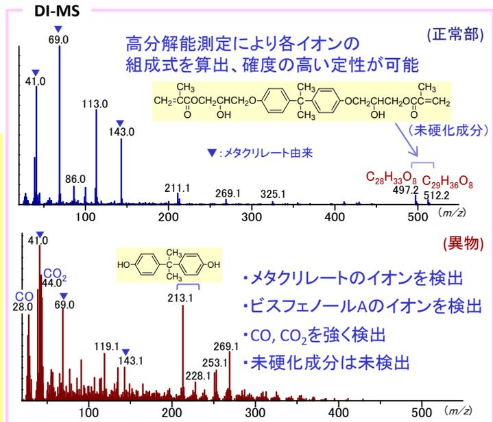
⇒ 異物はフィルムと同様のアクリル樹脂であり、フィルム自体の構造変化が外観不良の原因と推定。未硬化成分の減少などから、硬化反応が過度に進行したと推定。
