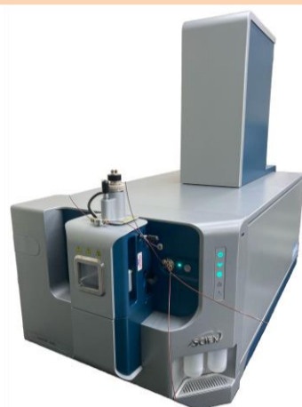
ZenoTOF 7600 (Q-TOF) (AB SCIEX) EAD搭載
