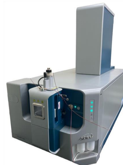
ZenoTOF 7600 (Q-TOF) (AB SCIEX) 高分解能、EAD搭載
