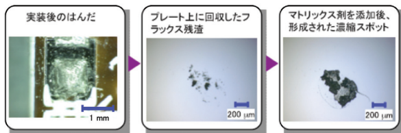
図3 フラックス残渣のピンポイント濃縮手順
